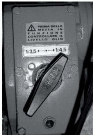
**Umschalten nur im Stillstand bei abgeschalteter Zapfwelle!**
