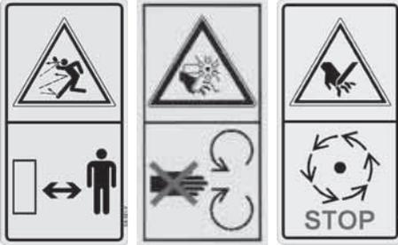
**Hinweisschild auf Verletzungsgefahr von Personen** (durch geworfene Gegenstände) **oder Verletzungen an den Händen** (Teile in Bewegung, wie z.B. Ventilator oder hintere Hydrauliktür).
