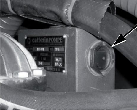
**Schauglas an der Pumpe zur Kontrolle des Ölstandes**
